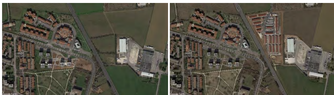
Figura 12. Consumo di suolo per la realizzazione di diversi fabbricati all'interno del tessuto urbano presso il comune di Verona. L'area vegetata nell'immagine di sinistra prima della realizzazione degli edifici era di circa 35.000 m 2 , sulla destra dopo l'intervento di edificazione e pavimentazione del terreno sono stati consumati circa 24.000 m 2 . Immagine 2020 a sinistra e 2022 a destra
