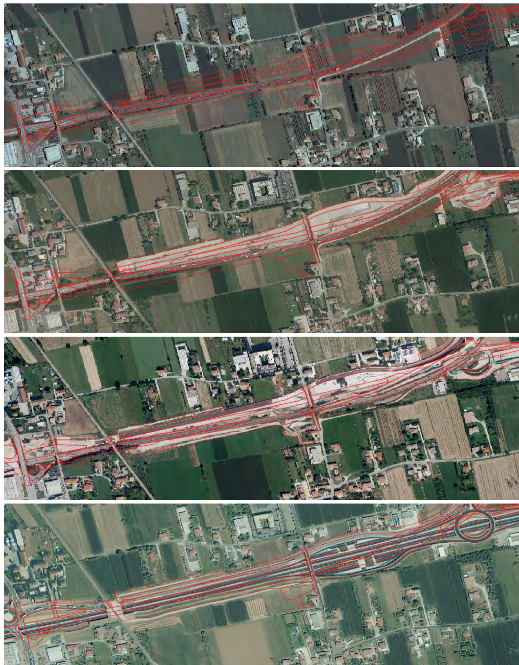
Figura 242. Revisione del monitoraggio del consumo di suolo in corrispondenza di un tratto di territorio interessato dalla costruzione della SPV. Dall'alto verso il basso la situazione al 2012, 2015, 2018 (ortofoto del relativo anno) e 2021 (immagine satellitare ad alta definizione)
