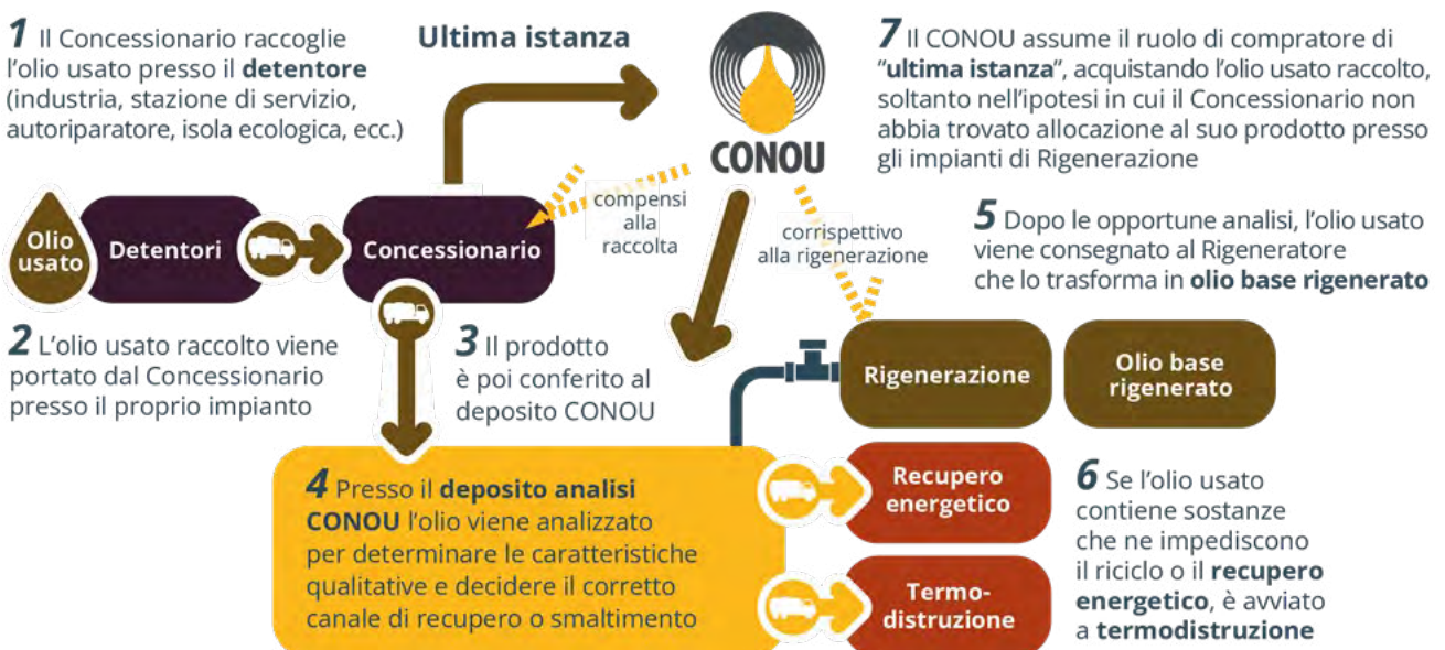
FIGURA 97 Fonte: Rapporto di Sostenibilità CONOU, 2023 Il sistema di raccolta e gestione degli oli usati del CONOU
