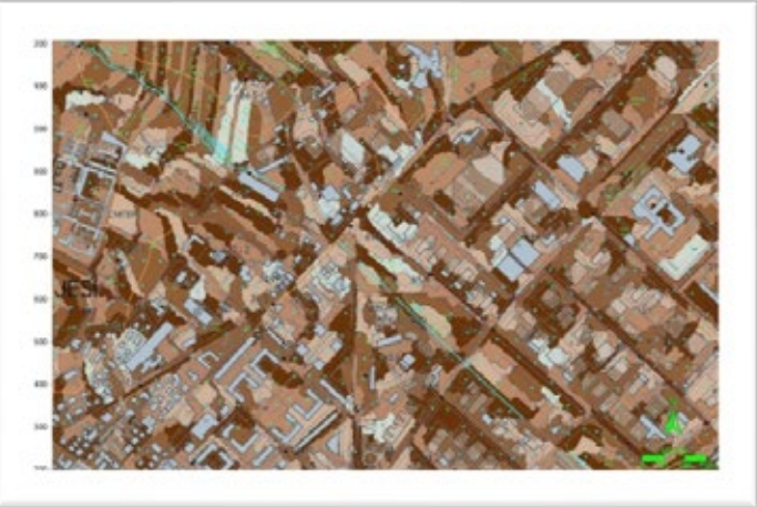
Fig. 3: In una realtà morfologica alterata come in un sistema urbano, occorre ricreare un sistema di deflusso idrico gestibile, in questo esempio si simula l'individuazione/creazione di micro-bacini di deflusso per l'utilizzo delle aree di infiltrazione di suolo.
